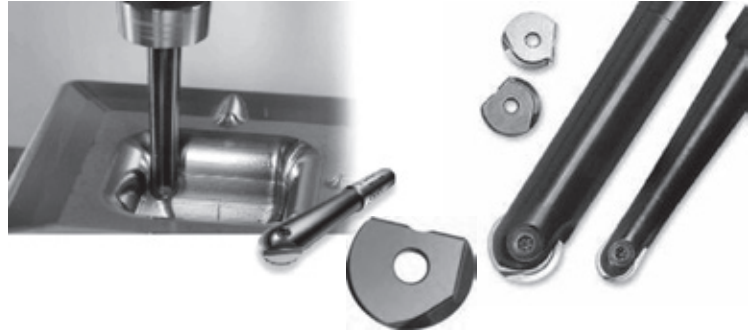
Figura 4. El cortador tipo lollipop. Imágenes obtenidas del fabricante DAPRA.
