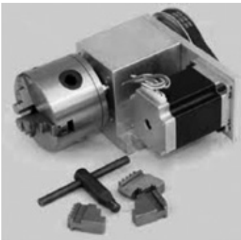
Figura 2. Cuarto eje marca Golden integrado al Centro de Maquinado Hyundai Kia KV25.
